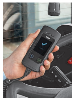
4. Akceptacja testu oddechowego: rozrusznik zostaje odblokowany.
